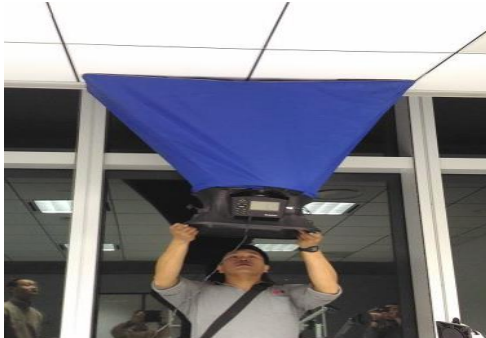
風量平衡測試
