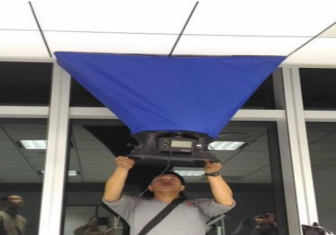
風量平衡測試
